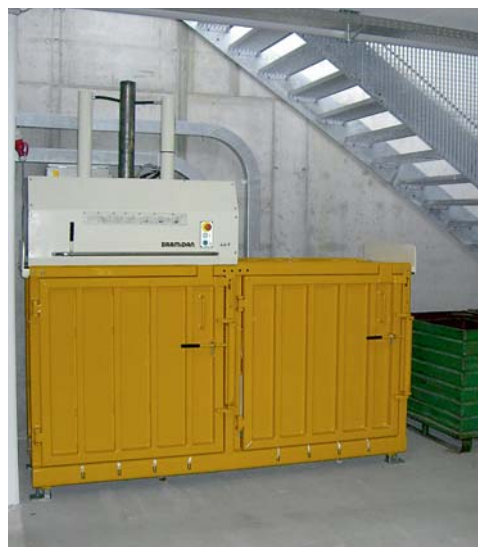
Zweikammer-Vertikalballenpresse für die Verarbeitung von zwei verschiedenen Materialien (z.Bsp. Karton und Folie)
