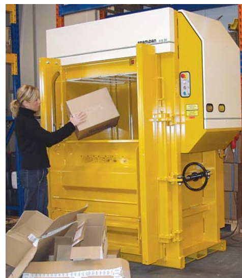
Vertikalballenpresse mit automatischer Schiebetüre verhilft zu speditiver Verarbeitung
