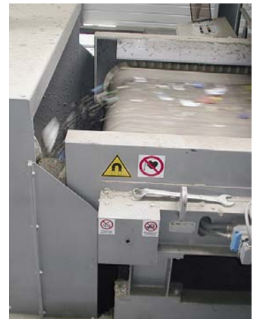
Trennungsscheitel bei Wirbelstromabscheider.
