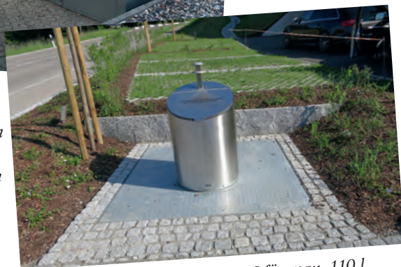
Unterflurcontainer Typ GTU 5m 3 für max. 110 l Kehrichtsäcke mit grosser Einwurfsäule Ø 670 mm. Ausführung KVA Thurgau.
