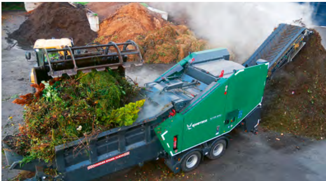
Doté d'un moteur de 462 chevaux et totalisant 19 tonnes, l'«Axtor 4510» peut être utilisé pour déchiqueter du bois ou pour broyer des déchets verts. Photos: Heinz Röthlisberger
