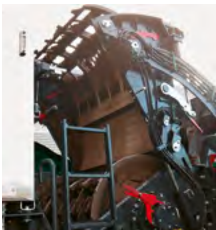
La possibilité de replier l'enceinte du rotor par un dispositif hydraulique assure une excellente accessibilité.
