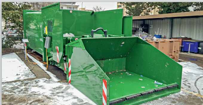
Pelle de chargement frontale – pour les dépôts des villes et des communes.
