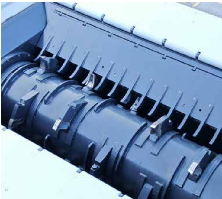
Blick in den Zerkleinerungsraum: Die Walzenlänge beträgt fast 3 Meter.
