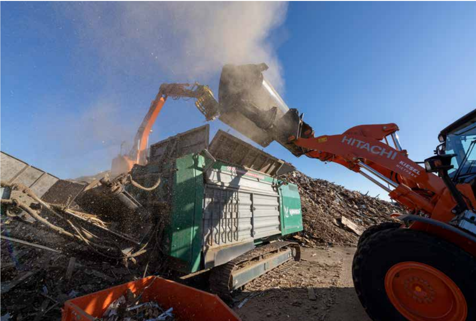
Mit dem Kettenlaufwerk steht der Crambo immer genau da, wo er gebraucht wird.
