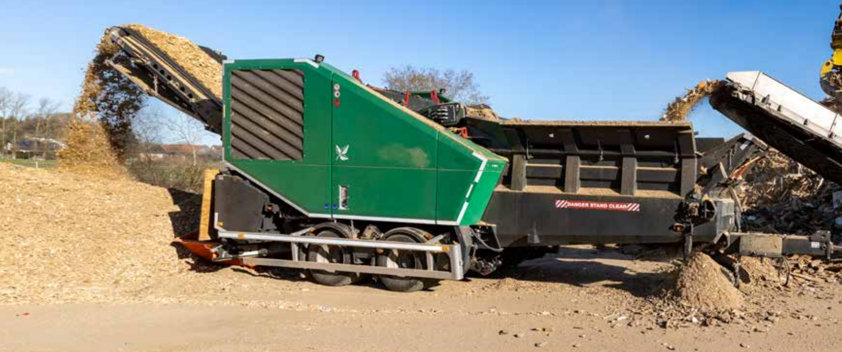
Einsatz Altholz: Der Crambo übernimmt das Vorbrechen, das Nachzerkleinern ist Sache des Axtors.
