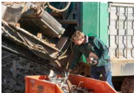
Wichtig: Eisen muss vor der Nachzerkleinerung heraus.
