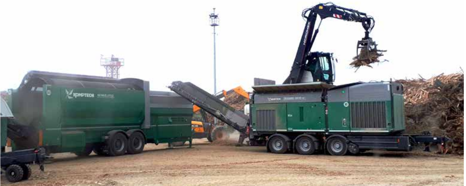
Der Crambo ist die ideale Maschine für die Vorzerkleinerung der Wurzelstöcke. Die Nemus kümmert sich um die Abtrennung von Erde, Sand und Steinen.
