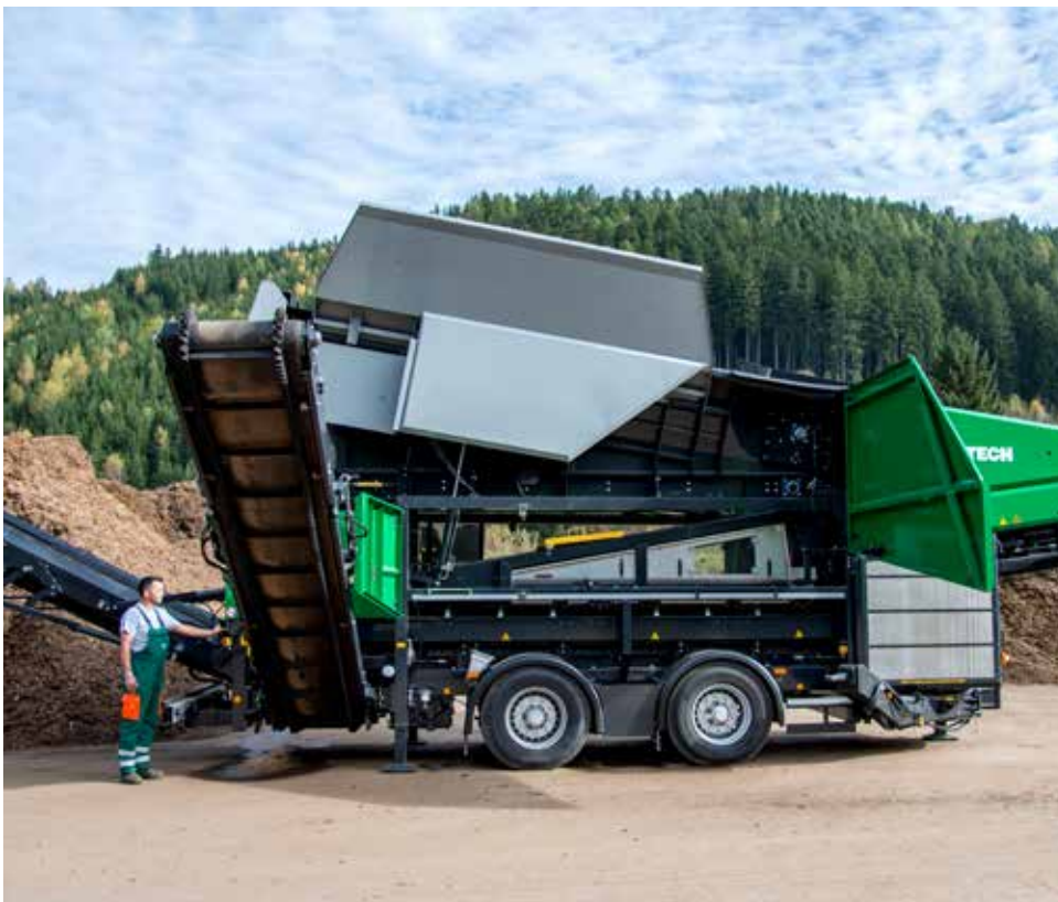
Der Aufgabebunker ist für Wartungszwecke anhebbar ist. Damit ist ein freier Zugang zum Feinsiebdeck über die gesamte Sieblänge möglich.
