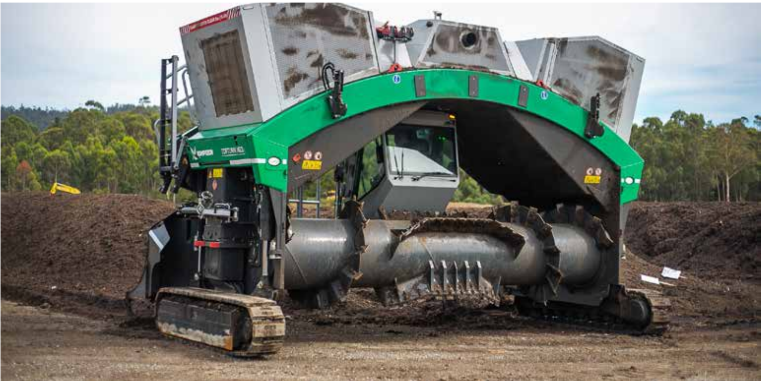
Der Topturn X63 ist für eine Mietenbreite von 5,7 Metern und eine Mietenhöhe von bis zu 2,6 Metern ausgelegt.
