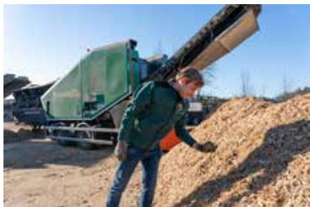
Einsatz Altholz: Der Crambo übernimmt das Vorbrechen, das Nachzerkleinern ist Sache des Axtors.
