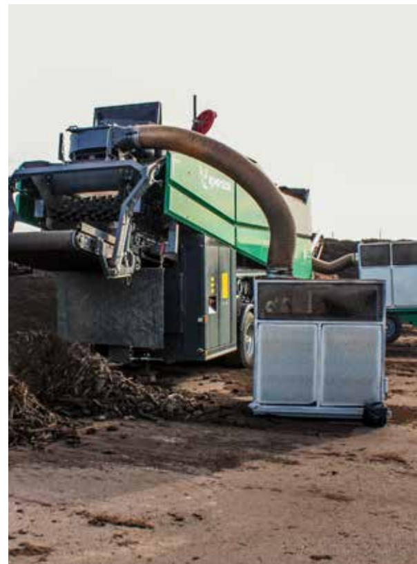
Windsichter über dem Grobkorn- und dem Mittelkornband verbessern die Produktqualität.
