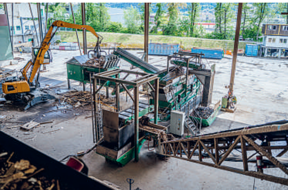
Par le biais d'un système de convoyage, le combustible peut également être transporté directement dans le réservoir de stockage de la centrale thermique.
