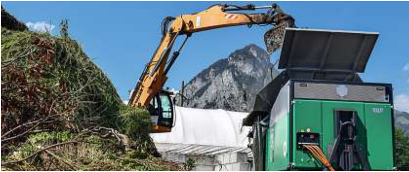
Der elektrische Grüngut-Schredder «CRAMBO 5000» im Einsatz.
